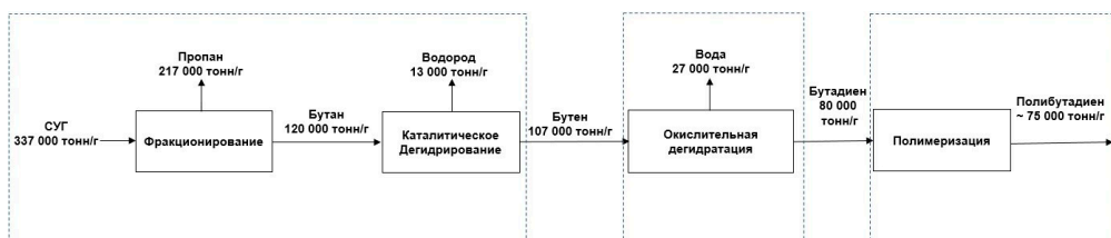
Рисунок 14. Верхнеуровневая схема получения полибутадиена из СУГ
