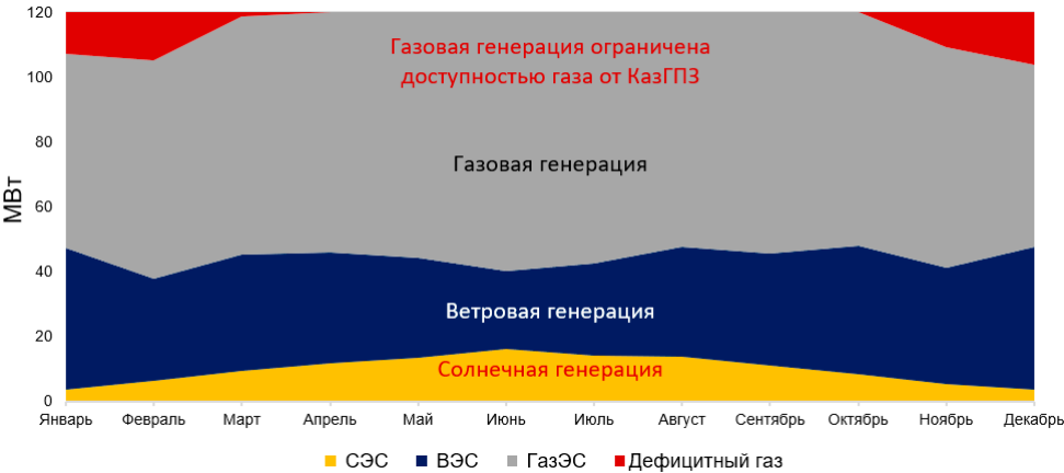
Рисунок 4. Генерация электроэнергии с учетом доступного газа
