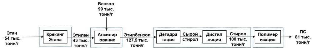
Рисунок 10. Блок-схема общего процесса по получению ПС
