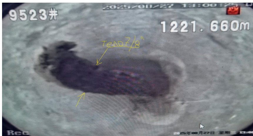
Рисунок 9. Показание прибора в виде «оборванного тела штанги 7/8*»
