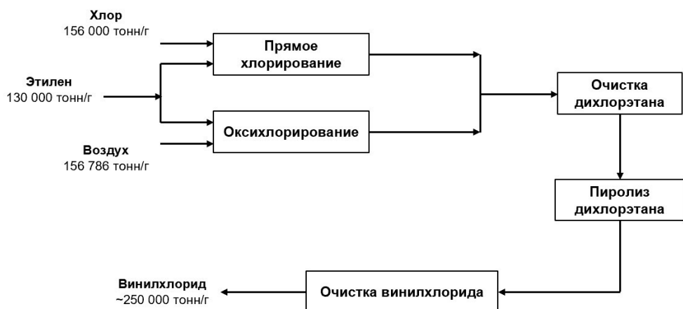
Рисунок 6. Технологическая схема получения ВХМ сбалансированным методом
