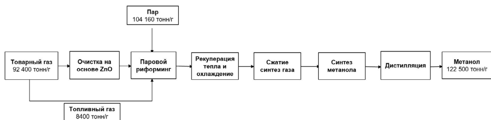
Рисунок 1. Схема получения метанола
