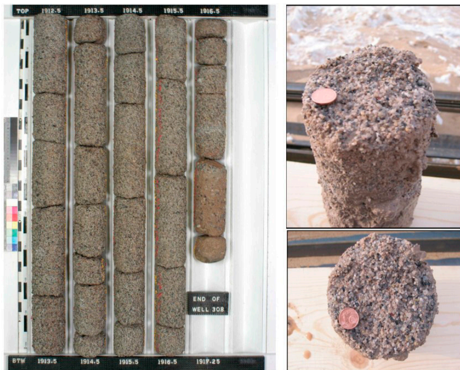
Рисунок 4. Фотографии керна по скважине №308
