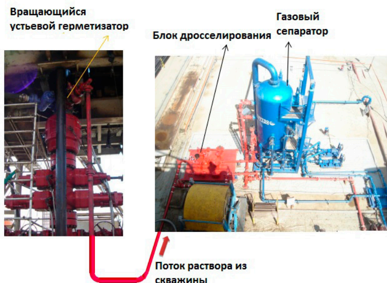
Рис. 4. Циркуляционная система однофазного MPD
