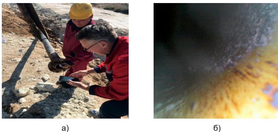
Рис. 4. Осмотр внутренней части ГКТ эндоскопом
