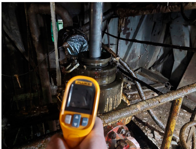
Рис. 9. Замер температуры роторного устьевого герметизатора
