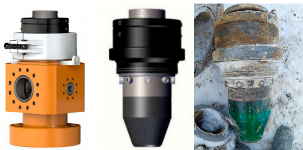
Рис. 7. Роторный устьевой герметизатор (РУГ) [2]
