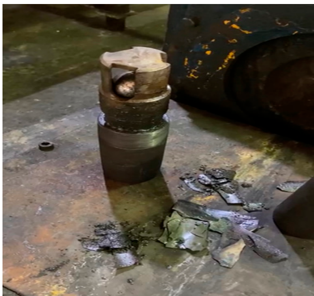
Рис. 2. Приемная клетка от ШГН со скважины 66* засорена защитным покрытием от НКТ
